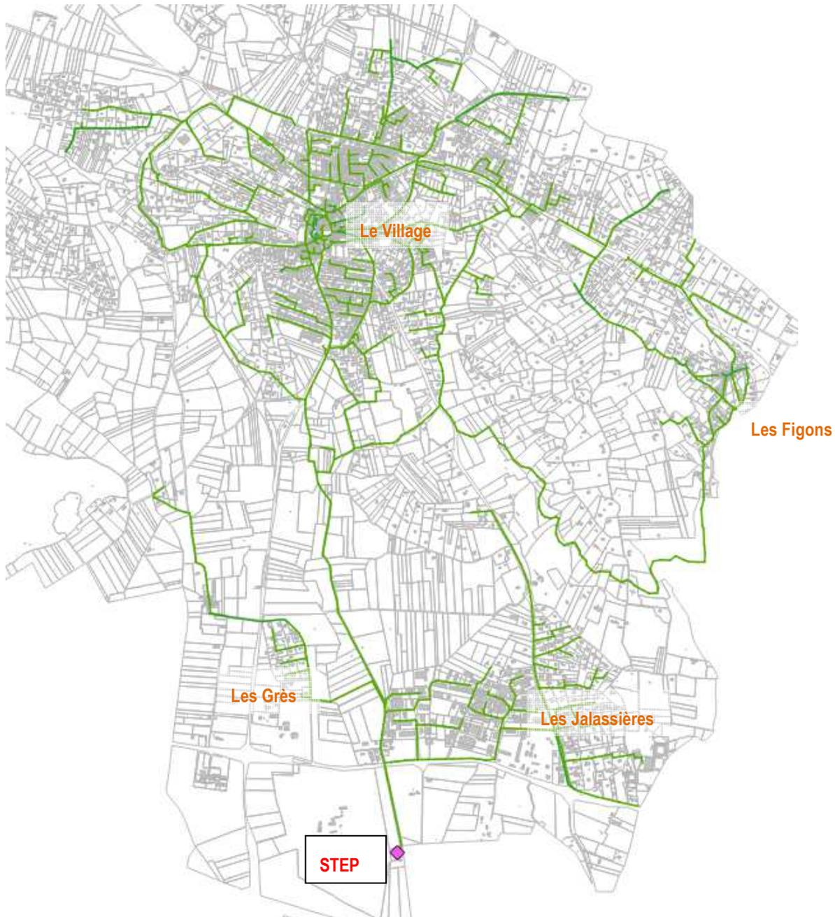
Figure 16 : Synoptique du réseau d'assainissement
